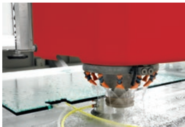
Периферическое шлифование по кромке.
