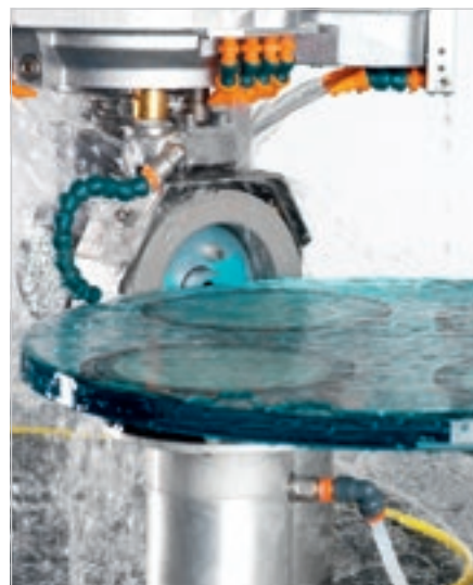
Шлифование чашевидным инструментом с помощью агрегата.
